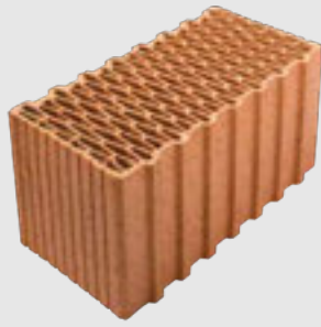
Porotherm 50 Plan U-Wert: 0,19 W/m 2 K (verputzt) Format: 50 x 25 x 24,9 cm Bedarf: 16 Stk./m 2
