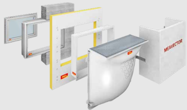
Das MEA Connect System mit seinen fünf aufeinander abgestimmten Komponenten (v.l.n.r.): beispielhafter Fenstereinsatz MEALUXIT; Fensterzarge MEALUXIT (in Betonwand); Montagedämmplatte MEAFIX; Perimeterabdeckrahmen; höhenverstellbarer GFK-Lichtschaft MEAMAX bzw. Beton-Lichtschaft MEAVECTOR
