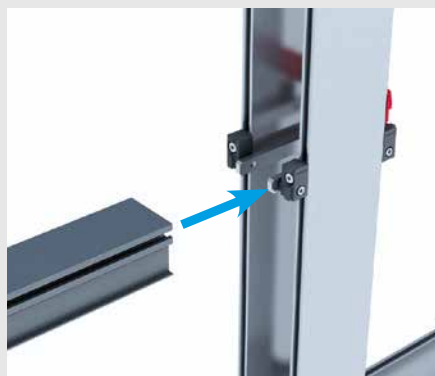
Laufschiene einstecken und fixieren
